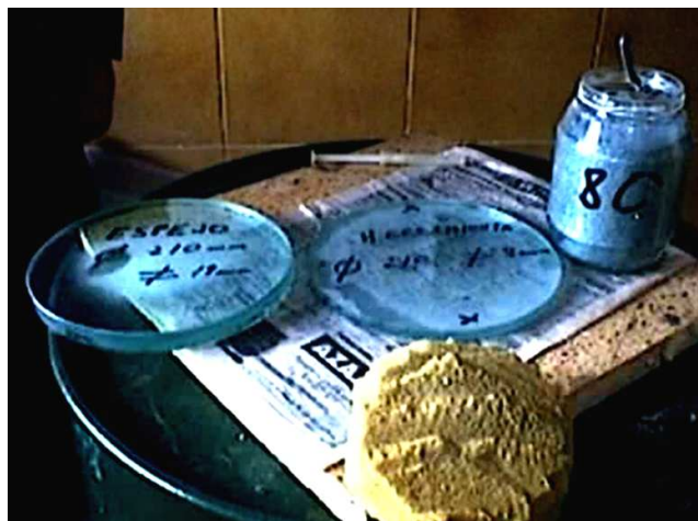
Banco de trabajo, con un espejo de 210 mm al principio de su tallado.
