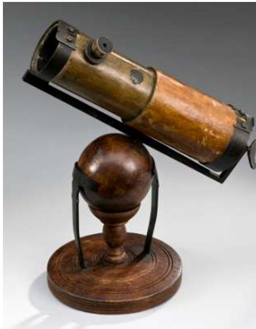
Telescopio construido por Isaac Newton. Los espejos de los primeros reflectores eran metálicos.
