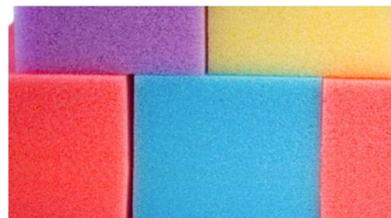
El reciclaje del poliuretano es a priori un proceso sencillo: la espuma residual se muele en granos y se trata con aditivos y celulosa para conseguir de nuevo un material de poliuretano útil.
